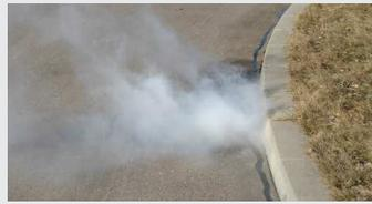
Für schwer zu ortende Leckagen und Fehlschlüsse. Produziert dichten, weißen Nebel, der mit leistungsstarkem Ventilator in Abwasser- oder Tankanlagen eingeblasen wird. 230V 50/60 Hz (10A), ca. 7,5 kg
